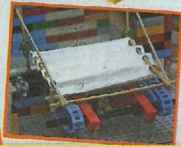
▲雨滴感應器可以檢測雨量大小，控制聰明雨擋自動捲起。
